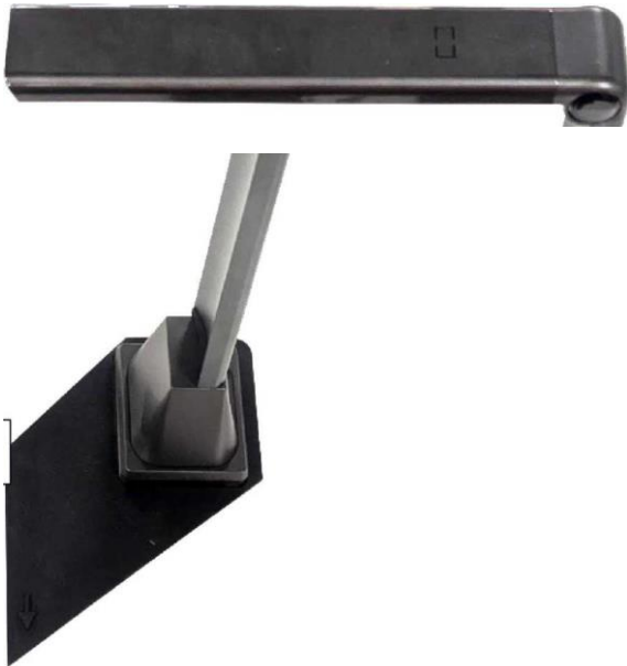
Rys. 3. Głowica kamery i podstawka pozycjonująca
